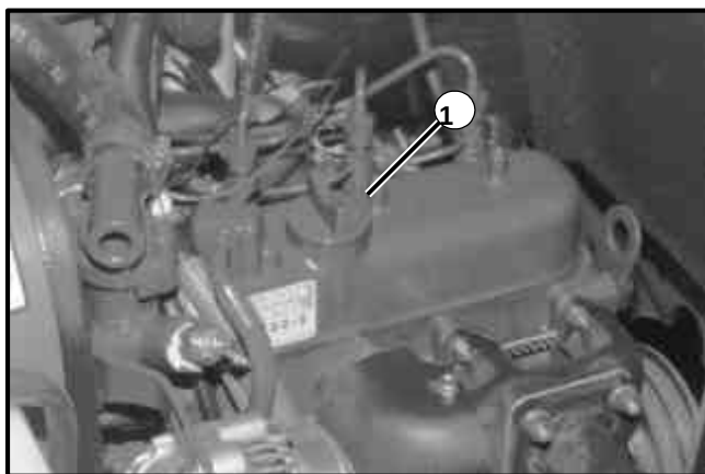
Figura 27 1. Porta di riempimento dell'olio (motore diesel)
